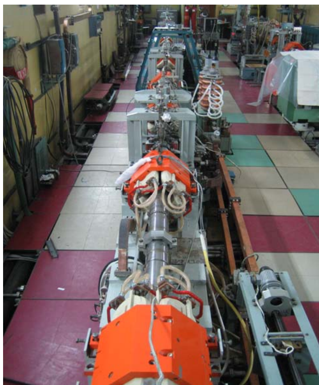
Рисунок 4. Фотография линейного ускорителя позитронов.
