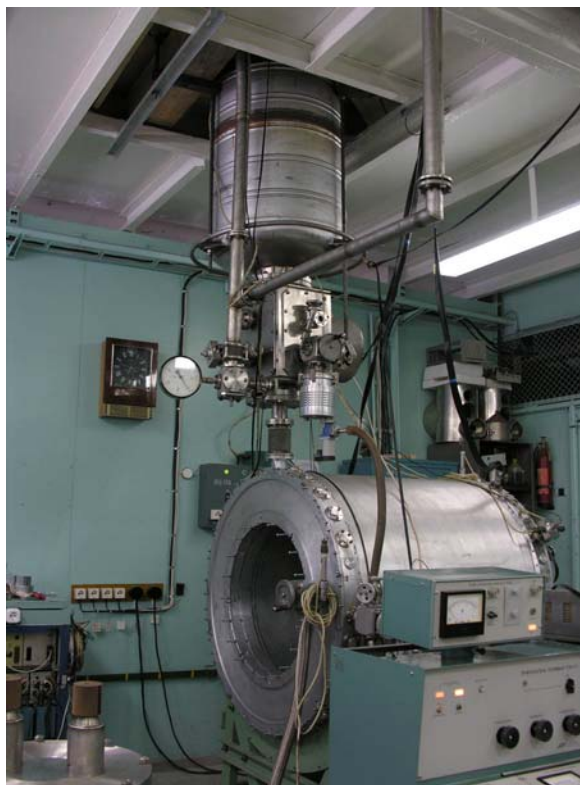
Рисунок 2. Сверхпроводящий соленоид детектора КМД-3 с криогенной системой.
